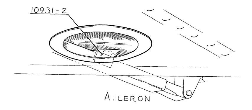
AILERON HINGE REINFORCEMENT BRACKET
